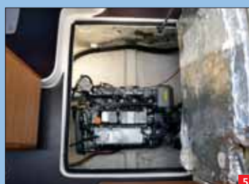
Un registro a la entrada del salón nos proporcionará un cómodo acceso al motor.
