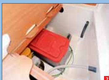
▲ El acceso a la hélice de proa también se halla bajo la cama de proa, en el cofre delantero.
