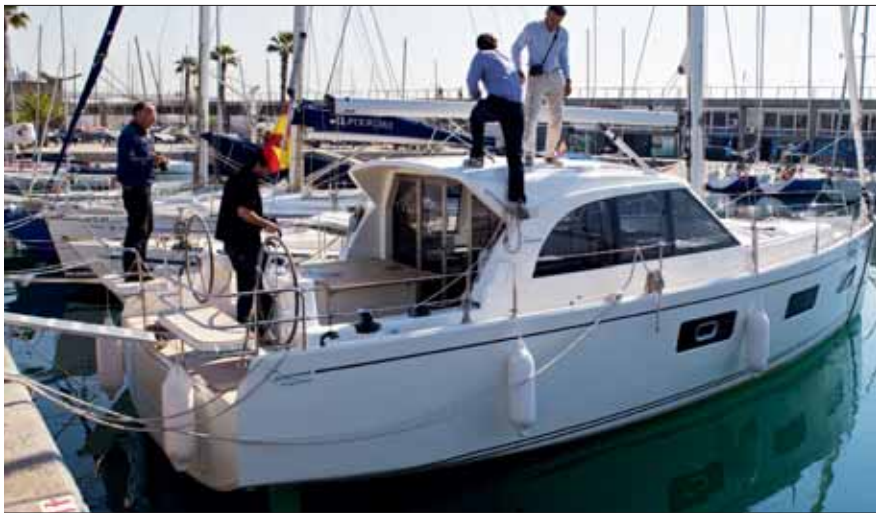
▲ El hard top es estructuralmente rígido, permitiendo la instalación de los reenvíos de la escota de la mayor, así como su uso como solárium. ▼
